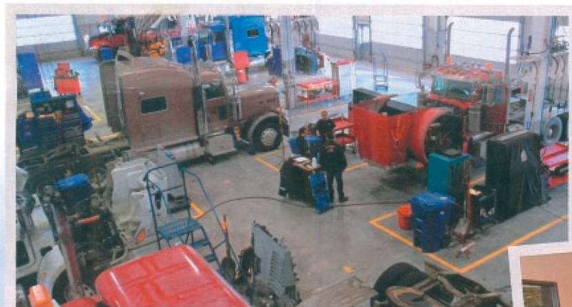
Le vaste atelier au plancher chauffant, comportant une aire d'alignement, 19 baies de service, ainsi qu'un rail suspendu d'une capacité de cinq tonnes, est facilement visible à partir du « salon des camionneurs ».
